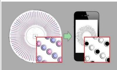
El sistema utiliza una tecnología microfluídica llamada SlipChip, que fue inventada en el laboratorio de Ismagilov hace varios años. Un SlipChip sirve como laboratorio-en-un-chip (plenamente portátil, por tanto) y puede ser utilizado para cuantificar las concentraciones de moléculas individuales.
